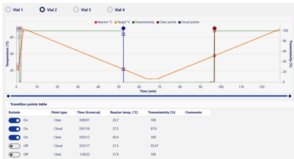
図 6 測定結果：各バイアルの温度、透過率及び検出された Clear Point、Cloud Point。
