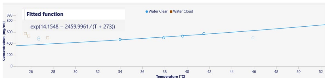
図 7 溶解度曲線 : Clear Point から Van't Hoff fitting により計算された溶解度曲線及び計算式。同様に Cloud Point から過溶解度曲線、2本の曲線から準安定領域を決定することができる。
