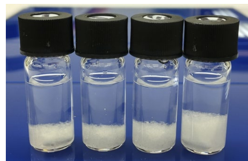
図2 調製した試料：硝酸カリウム(KNO 3 )をバイアルに秤取し、1mLの精製水を加え、Stirrer barを入れ、キャップを閉めた状態。
