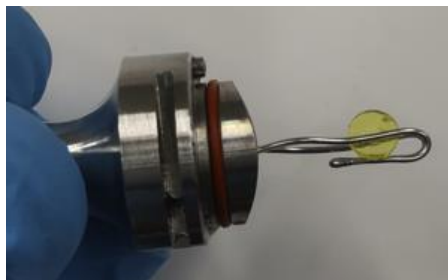
図 3. ステンレスクリップで固定された試料
