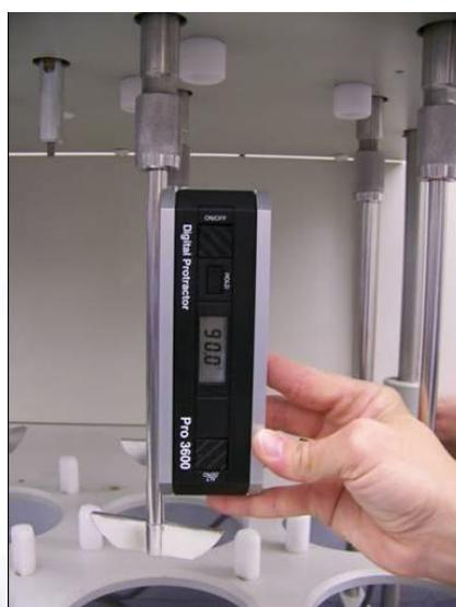
図 2. デジタル分度器を用いた攪拌機の垂直性測定
