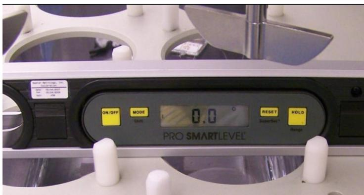
図 1. 試験装置のベースプレートで電子水準器の読み取り値が 0.0° となっている。
