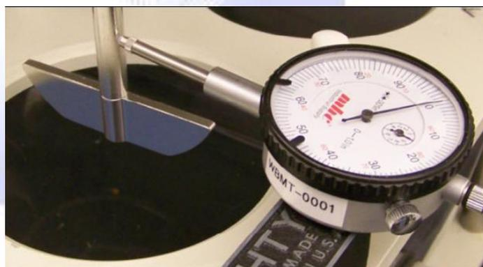
図 4. ダイアルテストインジケータ(ランアウトゲージ)。取り付けたパドルシャフトにプローブが接触しているところ(バスケットのふらつき測定は、底部バスケット縁にプローブチップを接触させて同様にを行う)。
